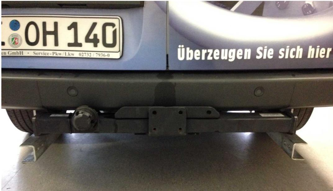
**Trittstufe komplett montiert**
