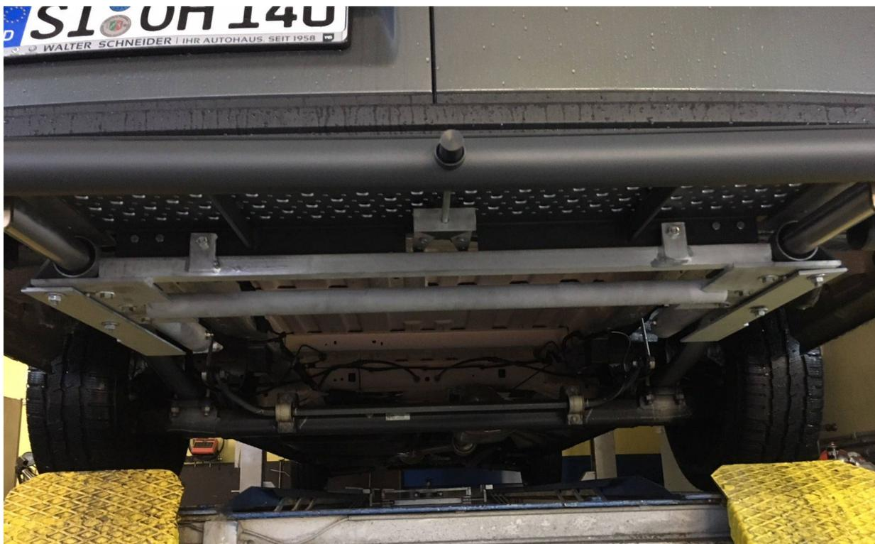
**Trittstufe komplett montiert**
